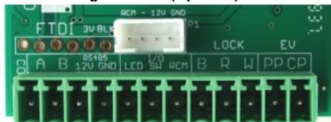
**A + B** wird für die Kommunikation mit der Sensorbox (nicht im Lieferumfang) benötigt.
